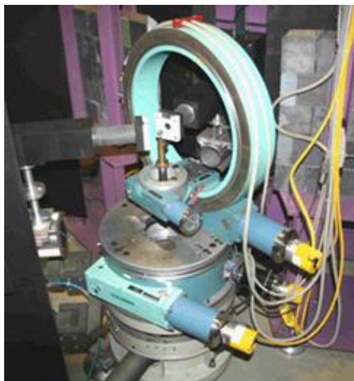
Дифрактометр TEX. Слева – узел образца, справа – узел монохроматора.
