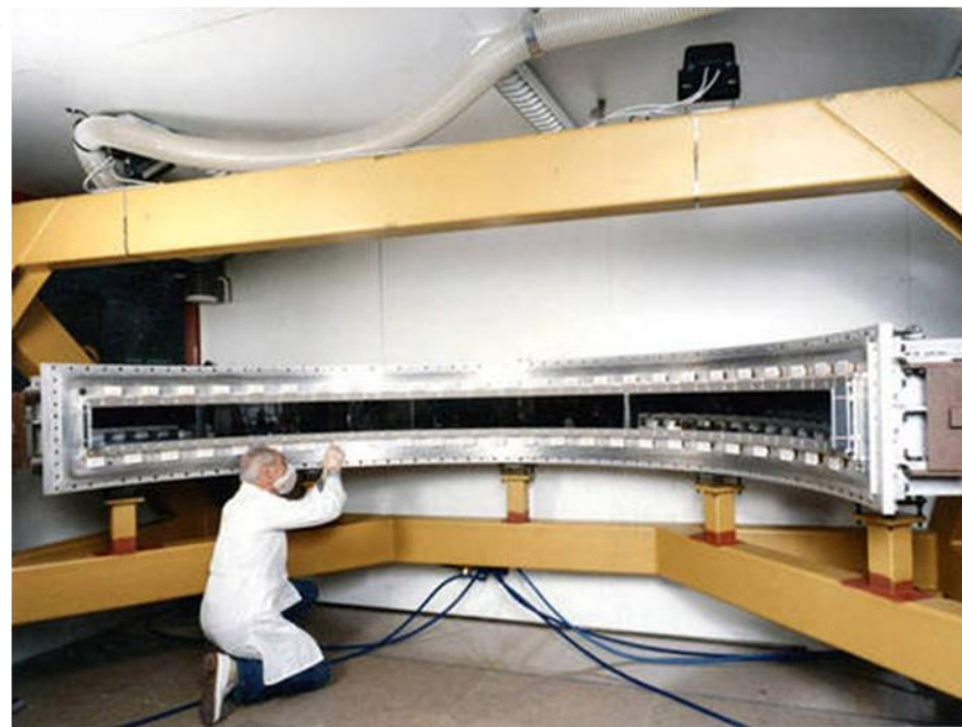
Монтаж микрострипового детектора для D20
