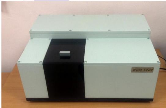
ИК Фурье-спектрометр ФСМ 1202 и оптический спектрометр Shimadzu uv-vis 2600
